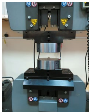
Рис. 4. Испытательная машина Инстрон 5988 перед началом эксперимента Fig. 4. Test machine Instron 5988 before the experiment
