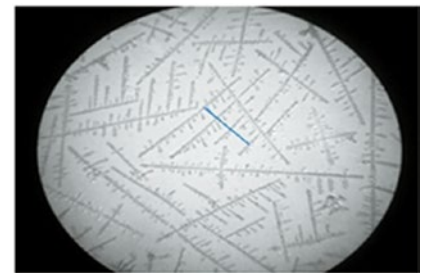
Рис. 3. Определение расстояния между дендритами при III типе МКС Fig. 3. Determining the distance between dendrites in type III ISS
