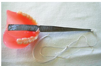
Рис. 2.16. Протез верхней челюсти с металлической пластиной, закрепленной на самотвердеющую пластмассу, для определения силы фиксации
