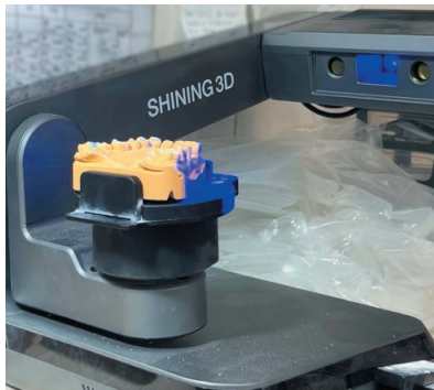
Рис. 2. Сканирование гипсовой модели Fig. 2. Scanning of a plaster model
