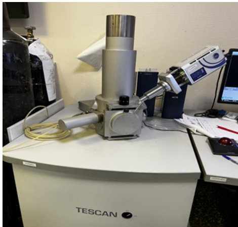
Рис. 1. Сканирующий электронный микроскоп (СЭМ) Tescan Vega 3 Fig. 1. Scanning electron microscope (SEM) Tescan Vega 3
