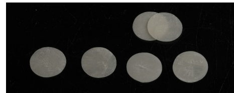
Рис. 1. Вид образцов для определения стойкости к окрашиванию, на примере материала Нолатек Fig. 1 View of samples for determining resistance to staining, using the Nolatak material as an example
