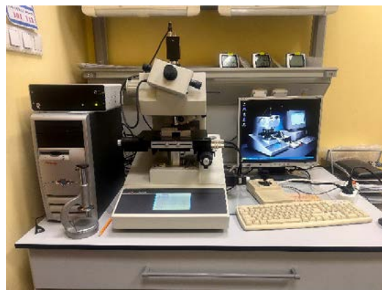
Рис. 1. Микротвердомер Duramin-20 (Struers, Дания) Fig. 1. Duramin-20 microhardness tester (Struers, Denmark)
