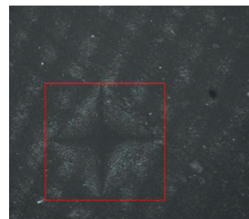
Рис. 6. Характер полученного отпечатка четырехгранной пирамиды на поверхности образца (масштаб 1:400) материала из Nolatek
