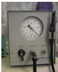
Рис. 115. Аппарат для проведения вакуумной пробы
