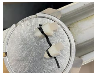
Рис. 3. Образцы зубов с адгезивно зафиксированными керамическими образцами, зафиксированные в модуле сканирующего электронного микроскопа JSM-IT300LV перед исследованием в режиме низкого вакуума
