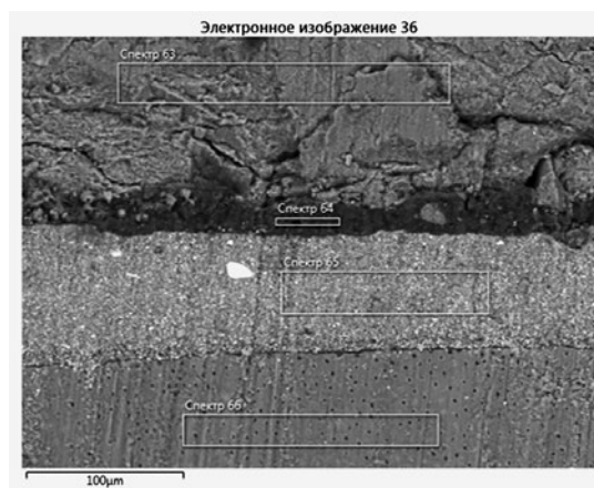
Рис. 4. Изображение участков исследования химического состава образца № 1: 1 — электронное изображение с зонами спектрального анализа (спектры 63, 64, 65, 66); 2 — суммарный спектр элементного состава Fig. 4. Image of the areas of study of the chemical composition of sample No. 1: 1 — electron image with spectral analysis zones (spectra 63, 64, 65, 66); 2 — total spectrum of elemental composition
