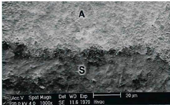
Рис. 50. REM-снимок: бесшовный переход пломбы Admira // VOCO (A) в эмаль (S)
