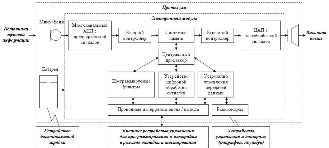
Рис. 1. Структурная схема устройства системы «бионическое ухо»
