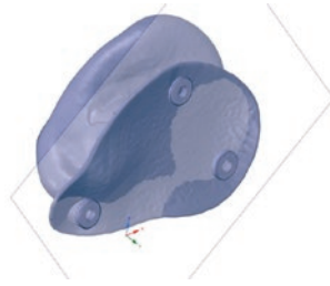
Рис. 6. Размещение крепежных элементов на плоскости протеза Fig. 6. Placement of fasteners on the plane of the prosthesis
