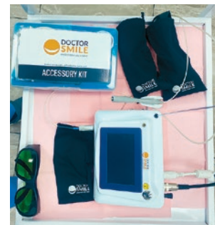
Рис. 3. Диодный лазер Doctor Smile Simplер с длиной волны 980 нм (Lambda SpA (Италия)) Fig. 3. Doctor Smile Simplер diode laser with a wavelength of 980 nm (Lambda SpA (Italy))
