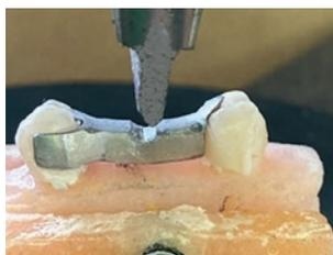
Рис. 6. Частичный откол малого фиксатора
