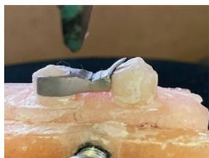
Рис. 5. Деформация окклюзионной накладке толщиной 1 мм на малом фиксаторе
