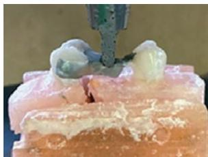
Рис. 7. Перелом пластмассового основания
