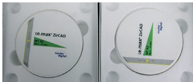
Рис. 2. Общий вид заготовки керамики на основе диоксида циркония «ZirCAD MT» для фрезерования зубных протезов
