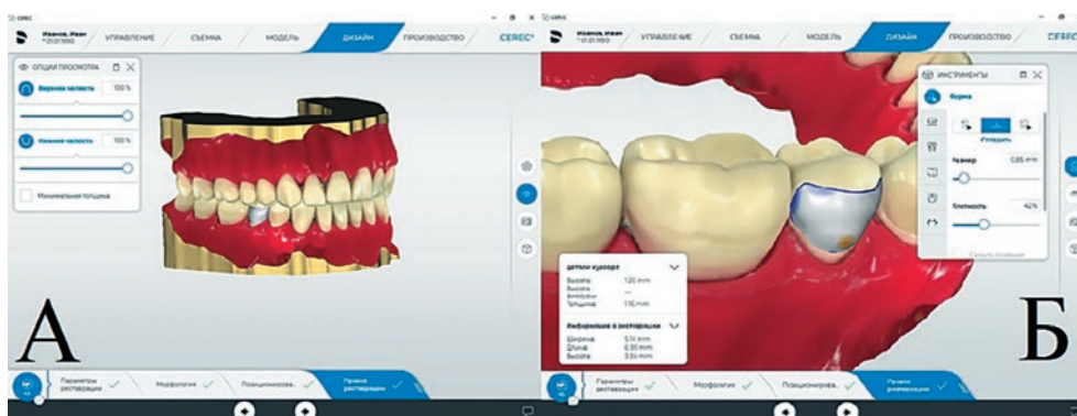
Рис. 6.1. Построение трехмерной модели будущей конструкции в программном пакете Cerec SW 5. А — автоматически построенная после сканирования модель. Б — формирование выпуклой подэкваториальной зоны
