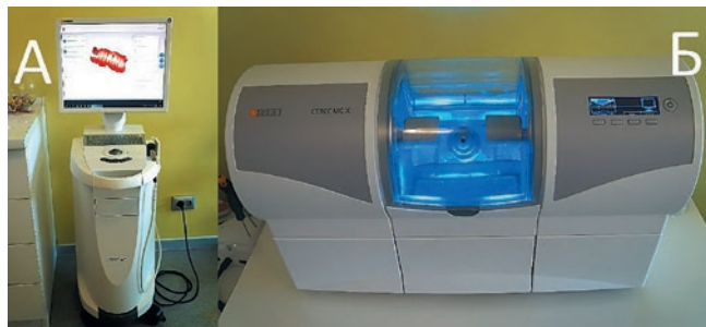
Рис. 4. Сканирующий модуль Cerec Omnicat (А), шлифовальный модуль Cerec MC X (Б) Fig. 4. Cerec Omnicat scanning module (A), Cerec MC X grinding module (B)
