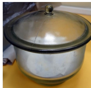
Рис. 2. Эксикатор с гигроскопическим порошком и мембраной, на которой размещали образцы сразу после изготовления Fig. 2. An desiccator with a hygroscopic powder and a membrane on which the samples were placed immediately after preparation
