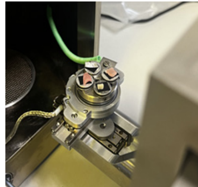
Рис. 2. Образцы фрагментов съемных ортопедических конструкций, подготовленных для проведения сканирующей электронной микроскопии, в камере СЭМ Fig. 2. Samples of fragments of removable orthopedic structures prepared for scanning electron microscopy in the SEM chamber
