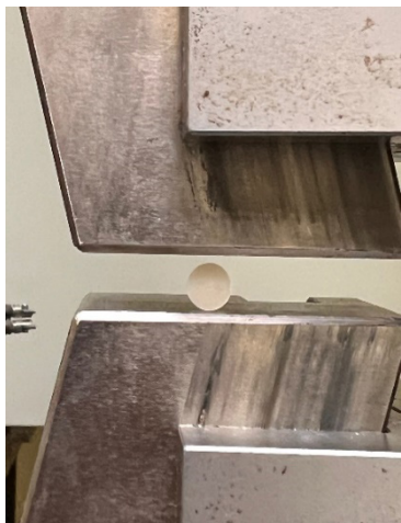
Рис. 2. Проведение испытания прочности при диаметральном разрыве
