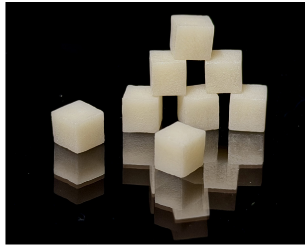
Рис. 3. Керамические образцы из материала E-max с основанием 5×5 мм
