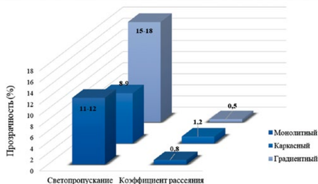
Рис. 5. Прозрачность основных видов диоксида циркония Fig. 5. Transparency of the main types of zirconium dioxide
