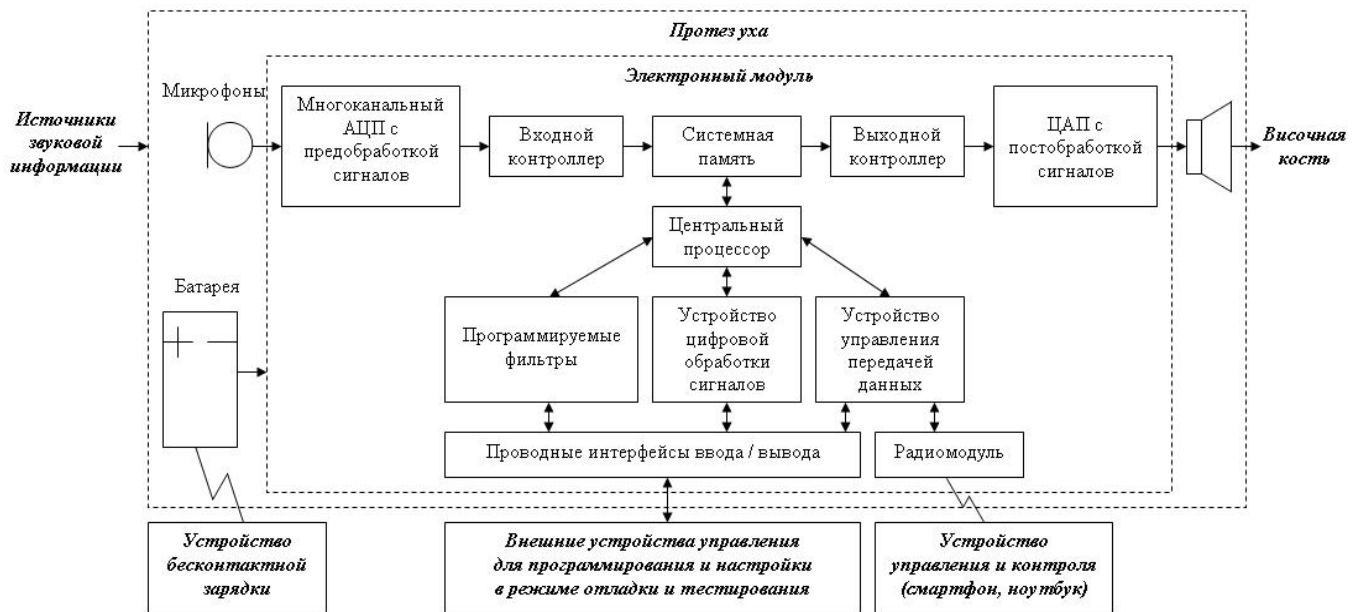
Рис. 1. Структурная схема устройства системы «бионическое ухо»
