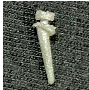
Рис. 1. Металлический штифт, произведенный методом селективного лазерного спекания Fig. 1. Metal pin produced by selective laser sintering
