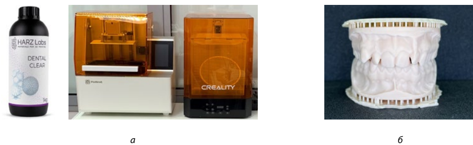
Рис. 7. Этапы лабораторного протокола по изготовлению СОРЦП в CAD/CAM-системе: а — прозрачная PMMA-подобная смола Dental Clear, 3D-принтер Pionext DJ89, промывочная станция и полимеризационная камера Pionext UW-02; б — вид готовых напечатанных рабочей и вспомогательной моделей
