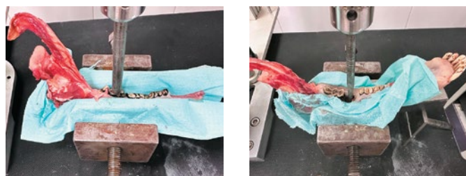
Рис. 2. Вертикально закрепленный нагрузочный элемент, позиционированный и опускаемый к челюсти с дальнейшим приложением давления и проведением нагрузочного теста: а — давление приходится на челюсть с моляром, б — давление приходится на челюсть с удаленным моляром, непосредственно на альвеолярную кость
