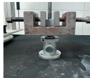
Рис. 4. Позиционирование кубиков-образцов в испытательной машине с помощью винтового держателя
