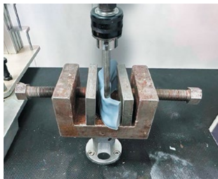
Рис. 7. Винтовой держатель для крепления моделей, фиксированный центральным винтом на основание универсальной испытательной машины GOTECH AI 7000S
