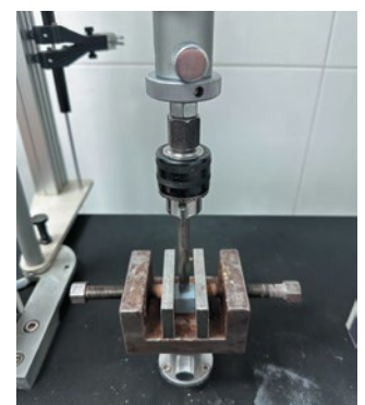
Рис. 5. Вертикально закрепленный нагрузочный элемент, позиционированный и опускаемый к образцу, с дальнейшим приложением давления и проведением нагрузочного теста
