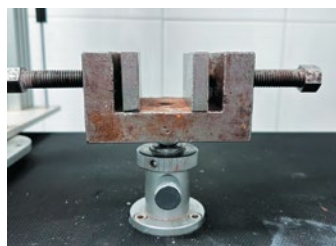
Рис. 1. Винтовой держатель испытательной машины GT-AI7000-S Fig. 1. Screw holder of the GT-AI7000-S test machine
