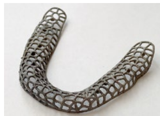
Рис. 2. Титановый каркас, полученный методом 3D-печати Fig. 2. 3D printed titanium frame
